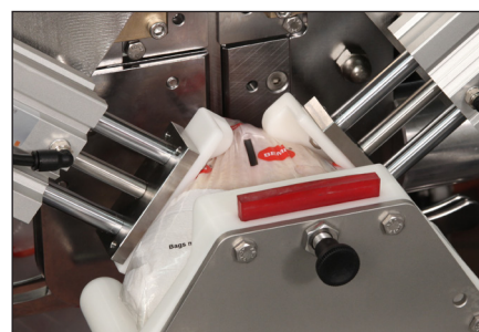
Das Beinklemmsystem hält die Geflügel während des Clipvorgangs in Position.
