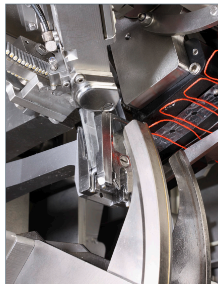
Shuttle-Clip-Technik: Verdrängen und Clippen – hoch präzise, schnell, kalibertreu und darmschonend.
