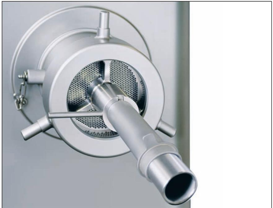
Ab Schneidsatzgröße D114 können die ULTRA MONO Automatenmischwölfe mit seitlichem Trennsatz und selbstregulierendem Federlauf ausgestattet werden. Die beiden Trennsatzarten zentral und seitlich können auch miteinander kombiniert werden. Das Duo Separat System besteht somit aus zwei unabhängig voneinander arbeitenden Trenneinrichtungen. Das Trennverfahren kann somit nochmal optimiert werden.
